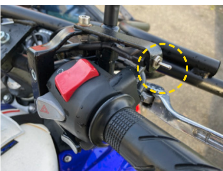
Utilisation d'un électroaimant relié au sélecteur de vitesses avec son contacteur à l'index droit afin de laisser la main gauche libre pour les clignotants et l'avertisseur sonore.
