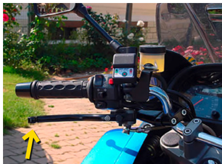
Commande de frein arrière déportée.
