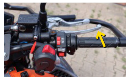
Déplacement de la poignée d'embrayage au guidon droit, sous la poignée du frein avant, à l'index droit, plutôt qu'au pouce, rendant ainsi possible la manipulation des clignotants ou de l'avertisseur sonore lors des phases de freinage.
