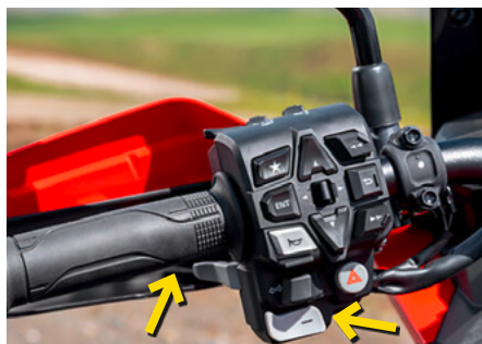
Sélecteur électronique à main gauche.
