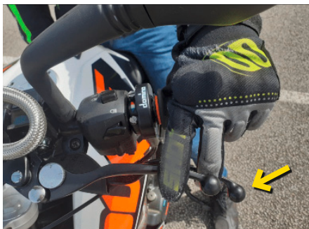
Commande de frein avant déportée côté gauche.
