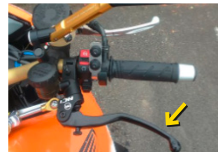
Déport du levier d'embrayage moto à droite (possible, mais assez peu utilisé, car il nécessite de monopoliser la main droite en plus des commandes de frein et d'accélérateur).
