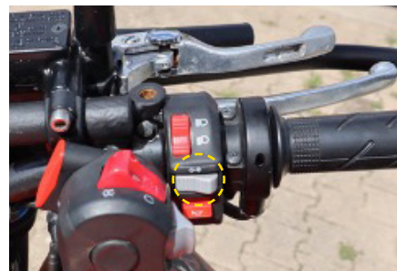
Déplacement du commodo des clignotants au guidon droit.
